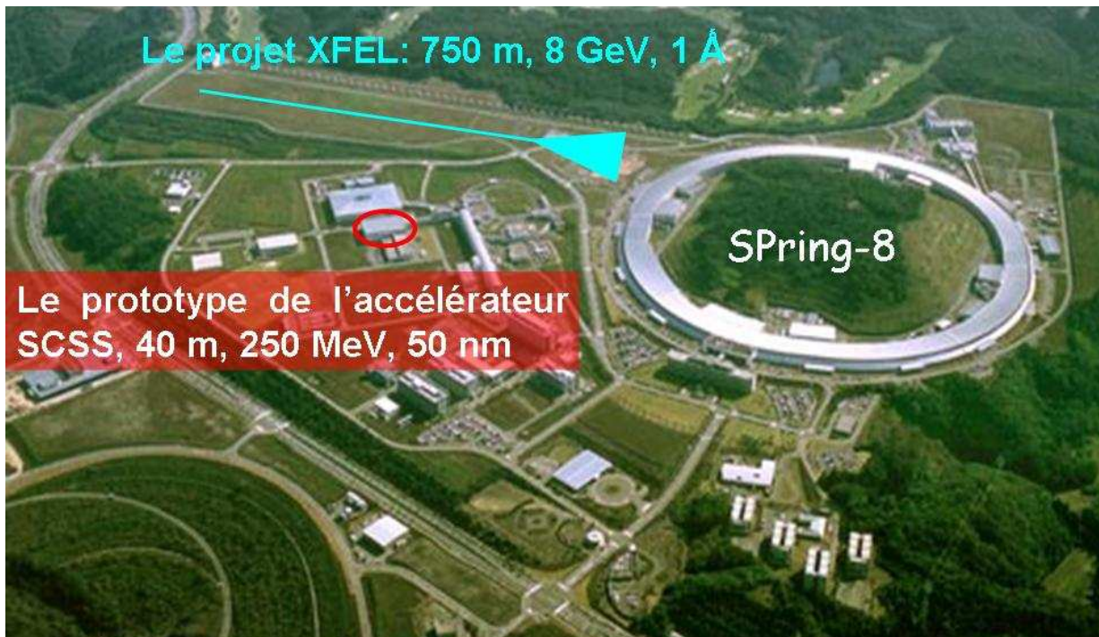
Figure IV-1- Vue aérienne du site d'implantation du Prototype de l'accélérateur SCSS, ainsi que du projet XFEL japonais.
