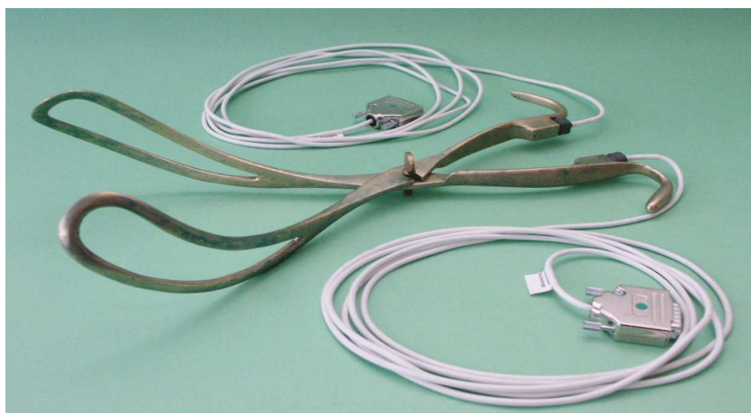
FIG. 2.30 – Forceps en bronze instrumentés avec des capteurs MiniBIRD 800
