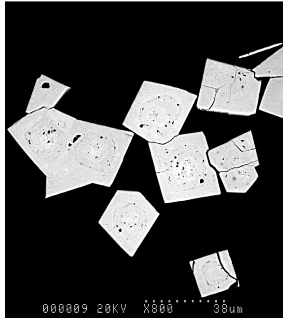
Photo 25. Photo MEB de pyrites présentant une zonation que l'on retrouve sur l'ensemble des cristaux.
