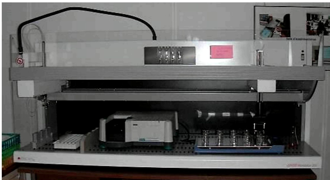
Figure 13 : Le spectrophotomètre et le robot diluteur dans le système Educ@ffix.net
