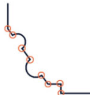
Figure 129 : Points de contrôle d'un profil mouluré
