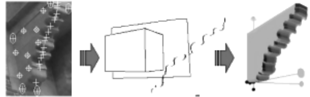
Figure 50 : Trois étapes du relevé d'une console: points étiquetés, boîte englobante plan de projection et profil, console (Expérience de l'ancien hôtel de ville de Cracovie, voir [Drap et al, 1999a] )
