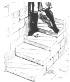
Figure 28 : problème de spécialisation du concept de volée d'escalier, l'escalier à marches en coin d'après [Noël, 1994, p154]
