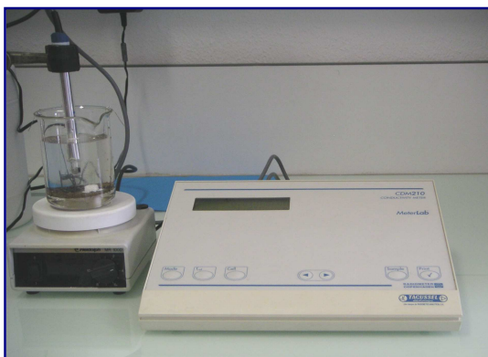
Figure II-8 : Photo et schéma du suivi de la dissolution des tablettes par conductimétrie
