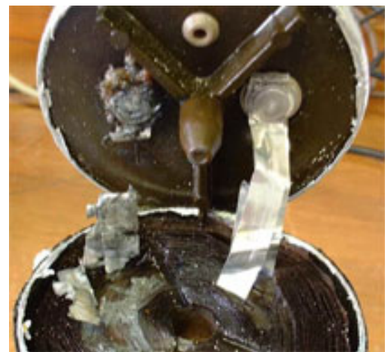
Figure 2-20 : Corrosion de l'anode d'un composant A.
