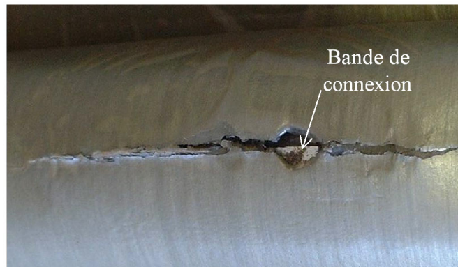
Figure 2-23 : Destruction du bobinage sur un condensateur du fabricant A.
