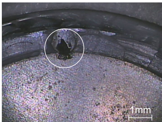
Figure 4-12 : Claquage d'un composant Tha (x40 et x200).
