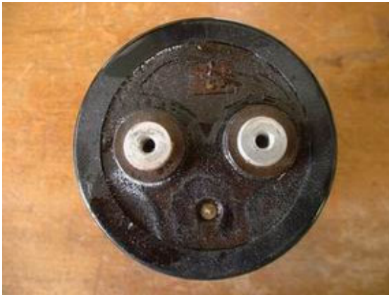
Figure 2-17 : Fuite d'électrolyte sur un composant A.
