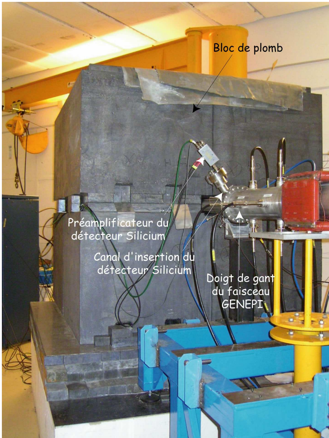
FIG. 3.8 – Photo du dispositif expérimental. On peut distinguer le guide du faisceau GENEPI situé à droite devant le bloc de plomb, ainsi que le dispositif utilisé pour insérer le détecteur Silicium dans le doigt de gant avec le préamplificateur associé.
