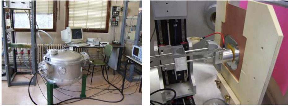
FIG. 4.15 – A gauche, vue d’ensemble du dispositif expérimental. On y distingue au centre, l’enceinte fermée ainsi que le PC d’acquisition. A droite, vue du système de détection à l’intérieur de l’enceinte. On peut y voir l’ensemble “collimateur - jonction silicium” installé pour la cartographie. Cet ensemble est situé à quelques millimètres seulement de la cible.
