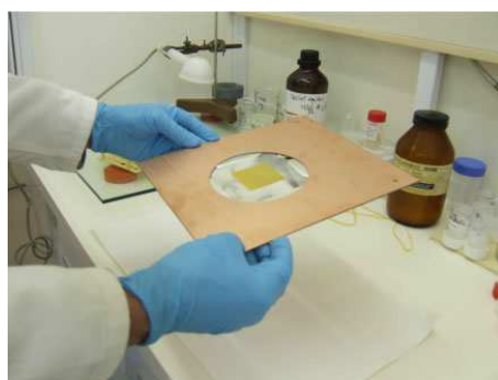
FIG. H.3 – Cible d' ^{235}\text{U} collée à son support pour sa caractérisation
