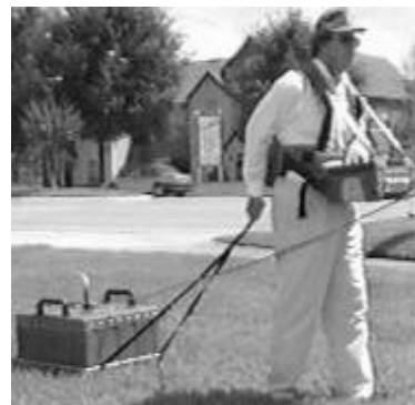
Ilustracja 20 Sprzęt i sposób dokonywania pomiarów przy wykorzystaniu techniki GPR (zob. GeoModel inc., Ground Penetrating Radar , http://www.geomodel.com/ )
