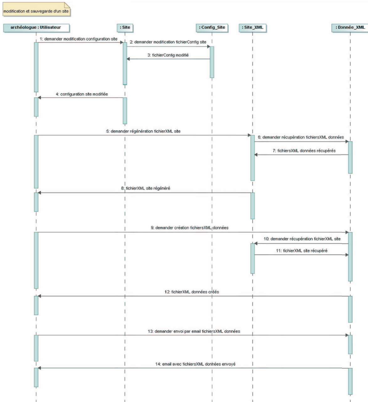
FIG. 10.8 – Diagramme de séquence décrivant la modification et la sauvegarde d'un site
