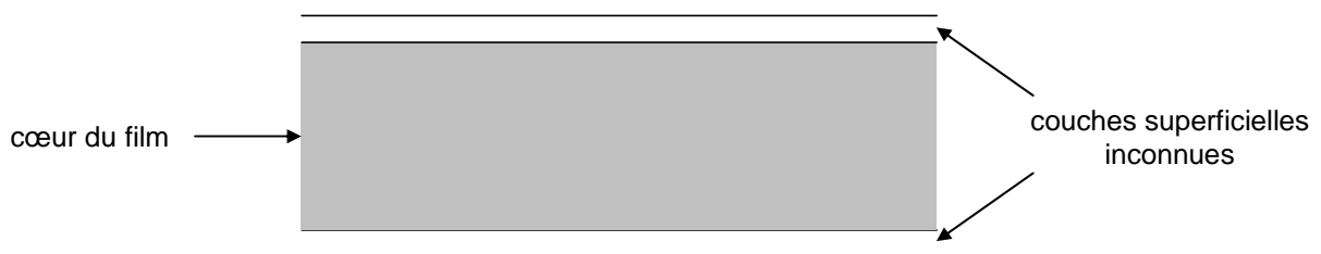
Figure 135 : Structure réelle des films de PET
