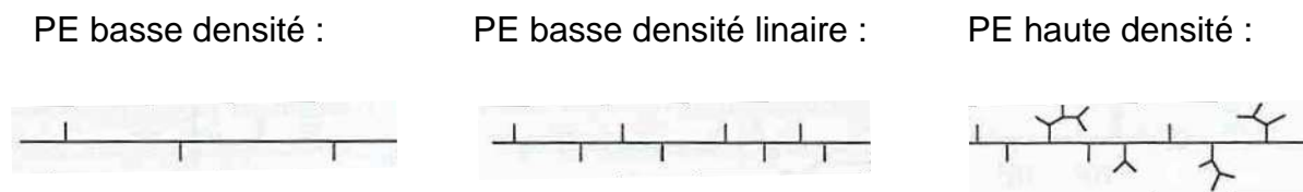
Figure 2 : Ramification suivant la densité du polyéthylène
