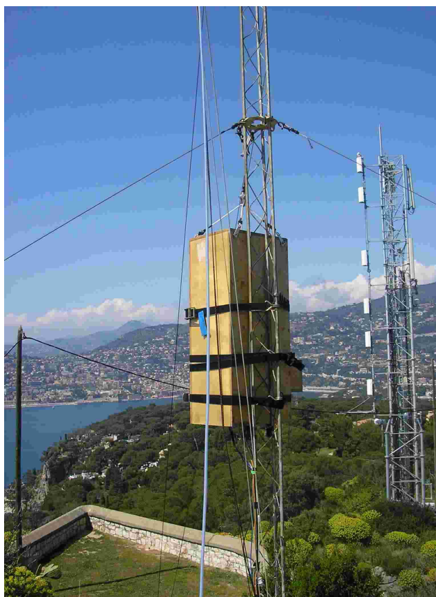
Figure III.3 : Le collecteur d'aérosols au site du Cap Ferrat.
