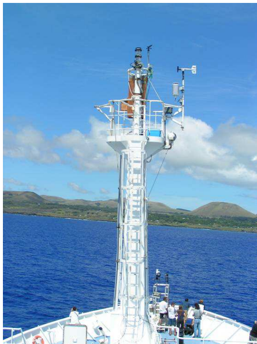
Figure III.8 : Collecteur d'aérosols sur le mat avant de l' Atalante lors de la campagne BIOSOPE
