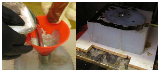
Figure 13 : Coulée manuelle du Cerrobend / Cerrobend coulé placé sous vide
