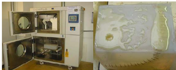
Figure 12 : Machine de coulée sous vide et coulée de l'os pariétal
