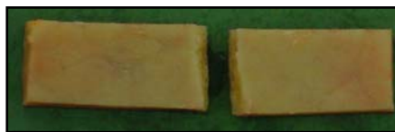
Figure 20 : Exemple de rupture "fragile"
