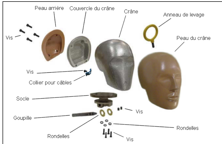
Figure 16 : Décomposition de la tête de l'HYBRID III
