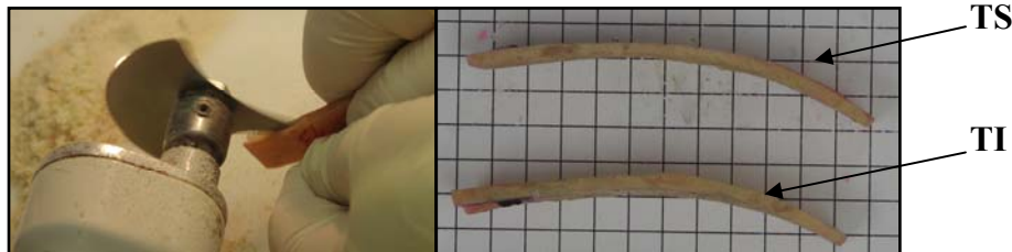
Figure 39 : Séparation des éprouvettes à l'aide d'une scie oscillante
