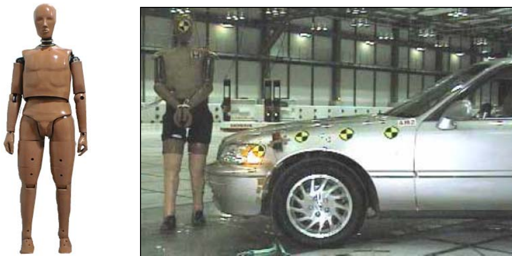
Figure 21 : Mannequin Pedestrian (gauche) et mannequin Polar dans sa configuration d'essai (droite)
