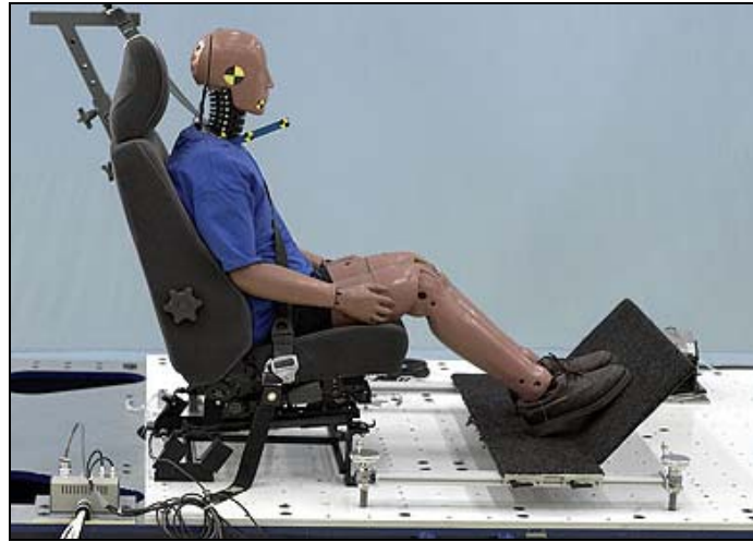
Figure 19 : Mannequin BioRID-II dans sa configuration d'essai
