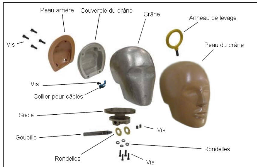
Figure 16 : Décomposition de la tête de l'HYBRID III
