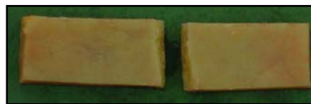
Figure 20 : Exemple de rupture "fragile"
