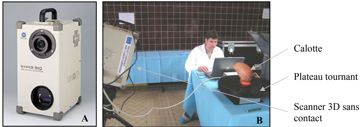
Figure 3 : Digitalisation 3D sans contact : A appareil et B dispositif expérimental
