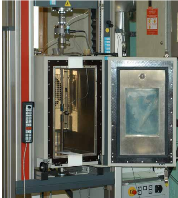
Fig. B.1 : Schéma du montage de traction simple : vue d'ensemble
