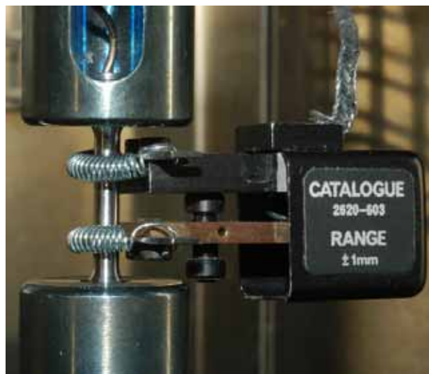
Fig. B.2 : Montage de l'extensomètre sur l'éprouvette
