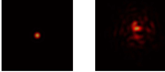
FIG. 5.5 – La figure de gauche montre une figure de franges tel qu'elle doit être obtenue pour une étoile seule sur l'axe optique en l'absence de turbulence optique avec deux télescopes de diamètre D=2 m sans obstruction centrale séparés d'une base de combinaison ( combination baseline ) de longueur B_0=8 m à la longueur d'onde \lambda=550 nm. Il s'agit d'une combinaison de type interférométrie de Fizeau dans le plan image [108, 130]. La figure de droite montre la même figure d'interférence en présence de turbulence optique. On a supposé que la base de collection ( collection baseline ) était de même longueur que la base de combinaison. Dans cet exemple obtenu par simulation numérique on a pris r_0(550nm)=20 cm et L_0=10 m avec le modèle de von Kàrmàn pour une couche turbulente unique située à une altitude h=500 m.
