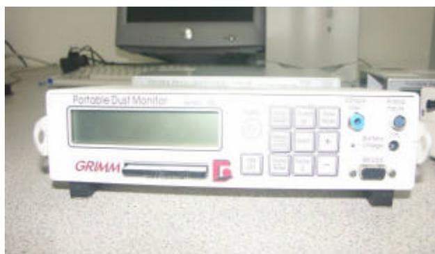
Figure III-9 Compteur optique, type GRIMM 1.108
