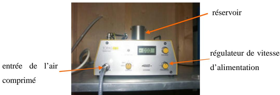
Figure III-8 Générateur des particules, type TOPAS
