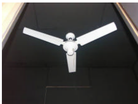
Figure III-3 Hélice installée sur le plafond de la grande cellule test
