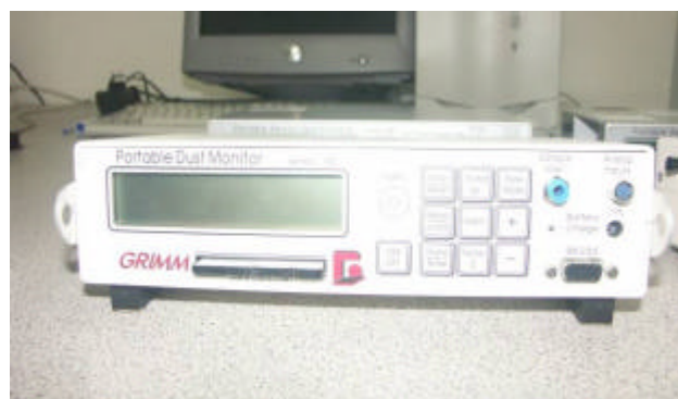
Figure III-9 Compteur optique, type GRIMM 1.108
