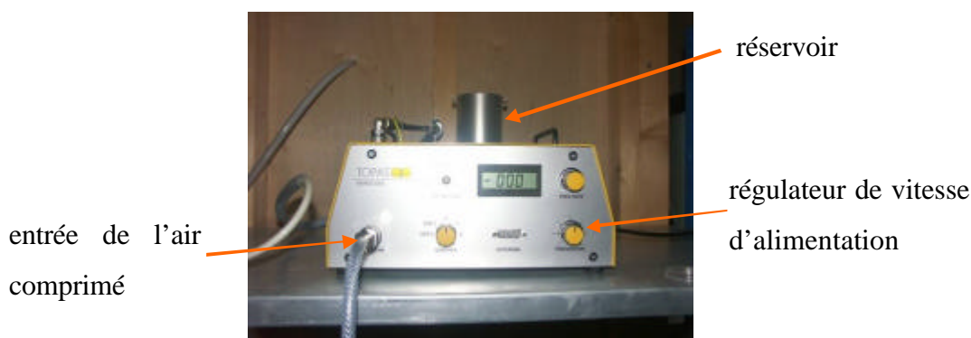
Figure III-8 Générateur des particules, type TOPAS
