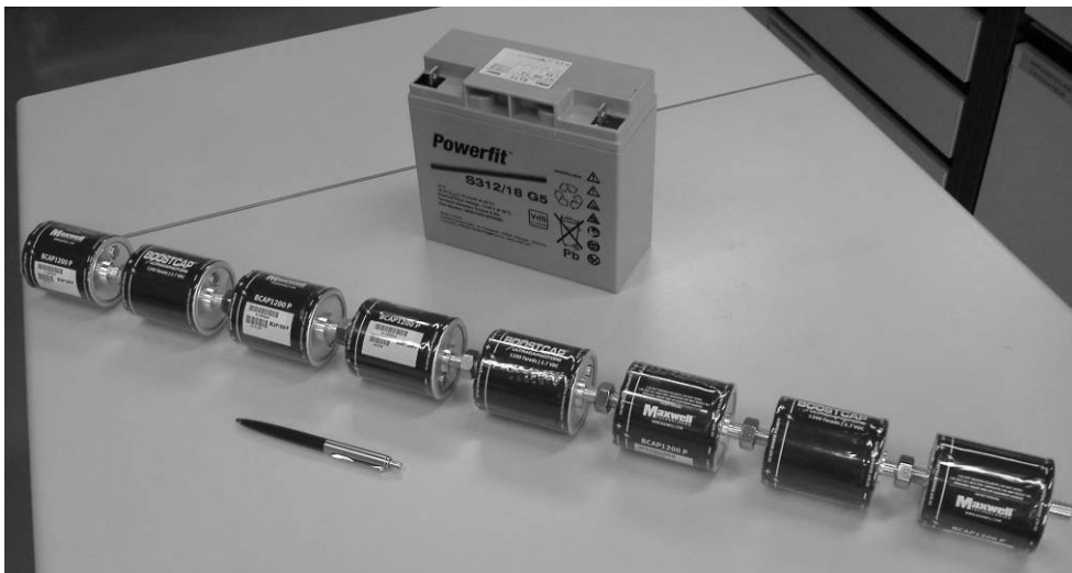
Figure 5-17 : Illustration de la batterie (haut) et des supercondensateurs (bas) utilisés sur la plateforme d'essais.
