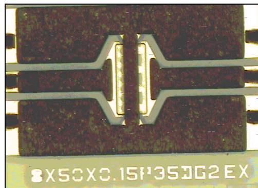
Figure 2-51 : photographie d'un transistor de développement de grille 8 \times 50\mu\text{m} sur technologie SiC du process TIGER.
