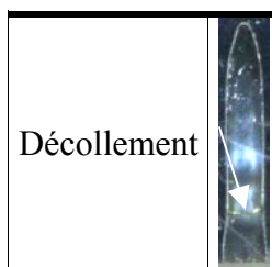
Figure 9-19 : Tableau illustrant le décollement à l'intérieur d'un perçage en méthode DODO.
