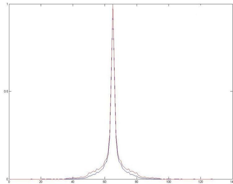
FIG. 14 – Coupes parallèle et perpendiculaire de la fonction d'autocorrélation de la Réponse Impulsionnelle  $S(\mathbf{r})$  de la caméra CCD intensifiée. L'effet de "flou" engendré par le tube intensificateur d'image s'étend sur 30X30 pixels environ. Cet élargissement est très important dans le calcul du Kernel.
