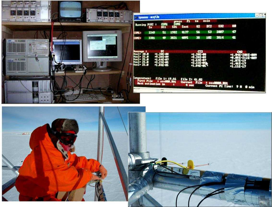
FIG. 1 – Installation des capteurs de fluctuations thermiques pour les mesures directes de  $C_T^2(h)$ .
