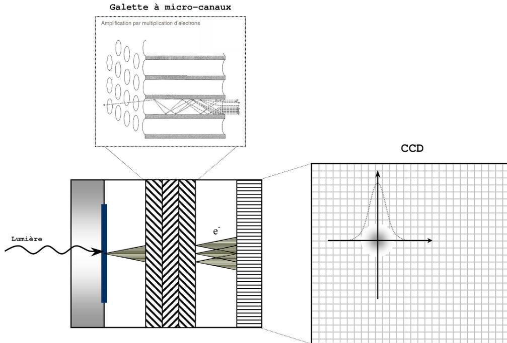
FIG. 8 – Schéma de l'intensificateur d'image qui a servi de détecteur pour cette étude.
