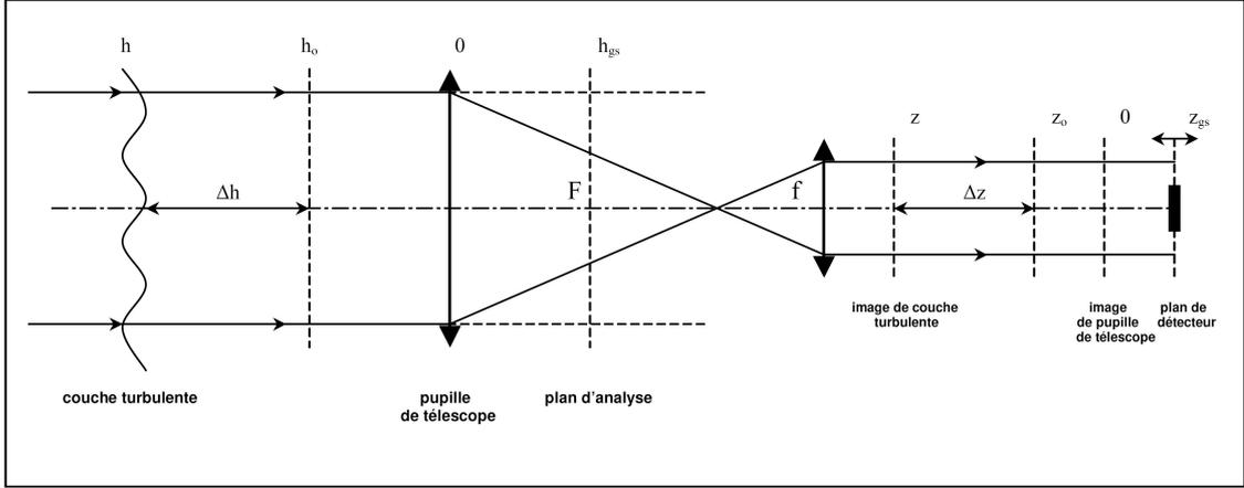
FIG. 4 – Schéma optique du SCIDAR Généralisé.
