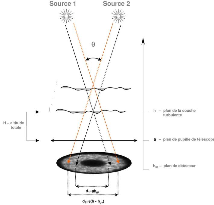
FIG. 1 – Principe d'observation avec le SCIDAR Généralisé.
