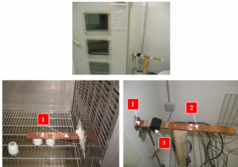
Figure 10 : Banc d'essai de mise en évidence du bouchon thermique
