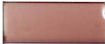
FIG. 1.4: Photographie d'un échantillon constitué d'un substrat de silice sur lequel est déposé un film mince (d'environ 100 nm d'épaisseur) contenant des nanoparticules d'or de 1,3 nm de rayon dispersées dans une matrice de silice (transparente), avec une fraction volumique en métal égale à 8%.
