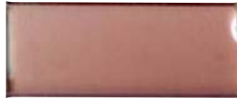
FIG. 1.4: Photographie d'un échantillon constitué d'un substrat de silice sur lequel est déposé un film mince (d'environ 100 nm d'épaisseur) contenant des nanoparticules d'or de 1,3 nm de rayon dispersées dans une matrice de silice (transparente), avec une fraction volumique en métal égale à 8%.
