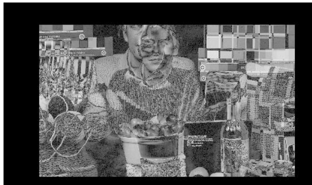
d. Différences des deux trames a et b avec (à gauche) et sans (à droite) compensation affine de mouvement.
