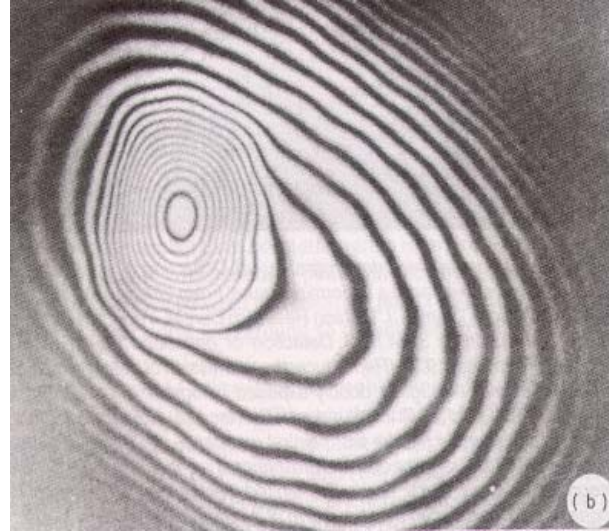
(b) Déflexion d'un composite en nid d'abeille [Ves79].
