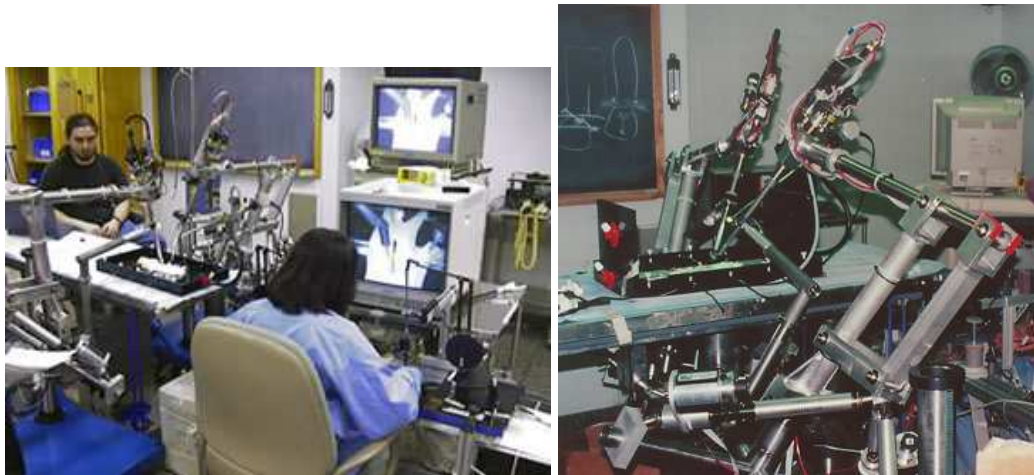
FIG. 2.15 – Système maître-esclave RTW de l'université de Berkeley. Vue d'ensemble à gauche, vue de l'esclave à droite.
