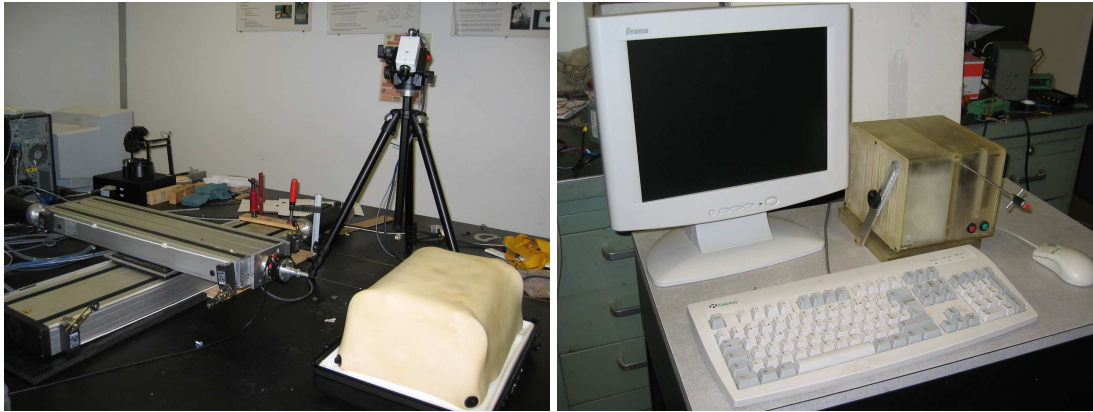
FIG. 5.1 – Dispositif expérimental pour l'évaluation des lois de commande bilatérale pour l'insertion d'aiguille. Robot cartésien XY à gauche et CT-Master à droite.
