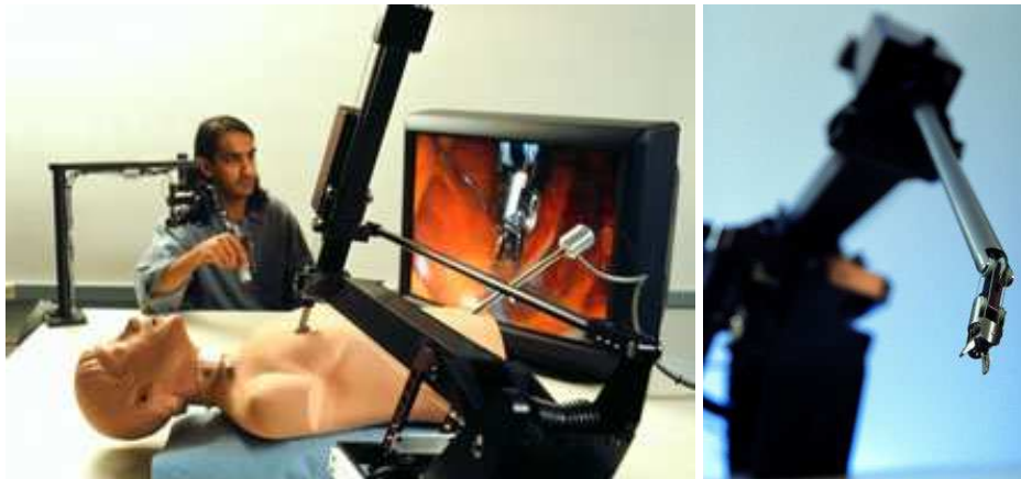
FIG. 2.19 – À gauche, le manipulateur esclave Black Falcon du MIT. À droite, l'organe terminal du Black Falcon.
