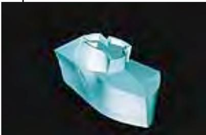
Travail sur la peau de la maquette. Les lignes représentent le calepinage du revêtement qui sera réalisé en panneaux de titane. Cette étape permet de calculer les quantitatifs de l'enveloppe. Si la forme génère une surface trop importante et accroît le coût de l'ouvrage
