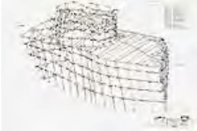
A cette étape, la modélisation sous Catia est utilisée pour générer les dessins d'exécution du constructeur métallique. Les pièces de charpente en acier ont ainsi été découpées, percées et soudées en atelier par des machines à commande numérique.
