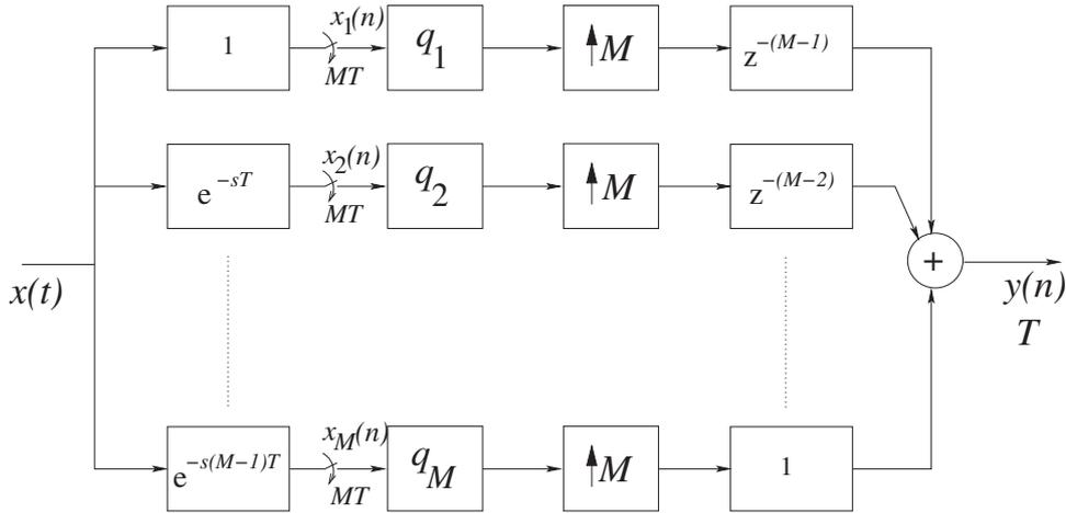
**Fig. 2.9** Convertisseur à entrelacement temporel - schéma de principe
