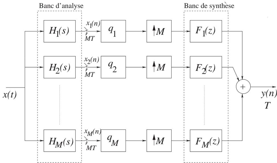
**Fig. 2.11** Banc de filtres hybride à temps continu
