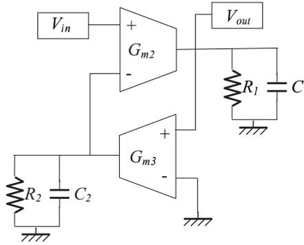
**Fig. 3.4** Résonateur  $Gm$ - $C$  - circuit II
