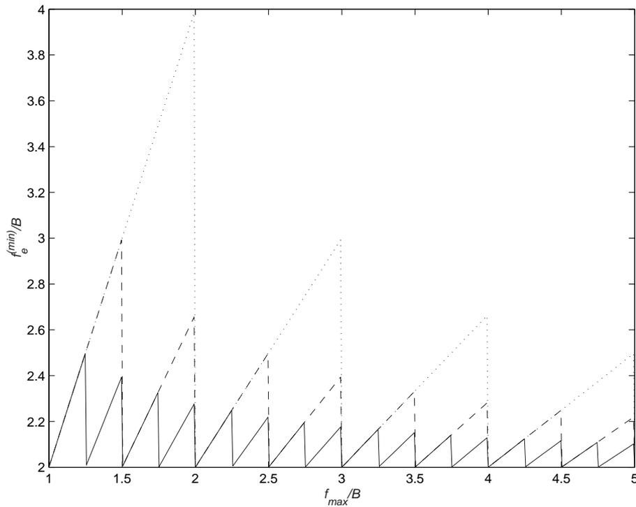
**Fig. 4.1** Fréquence d'échantillonnage minimale ( $f_e^{(min)}$ ) en fonction de la fréquence maximale ( $f_{max}$ ) - en petits pointillés : pour un seul CAN; en gros pointillés : pour un BFH à quatre voies; en ligne pleine : pour un BFH à huit voies
