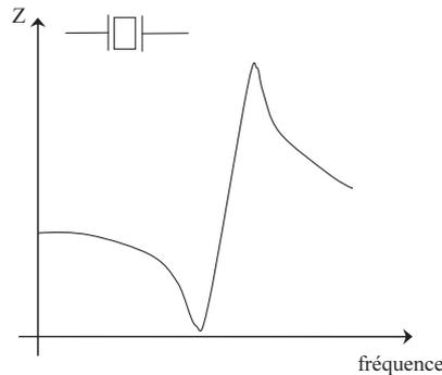
**Fig. 3.5** *Module de l'impédance d'une résonateur BAW*
