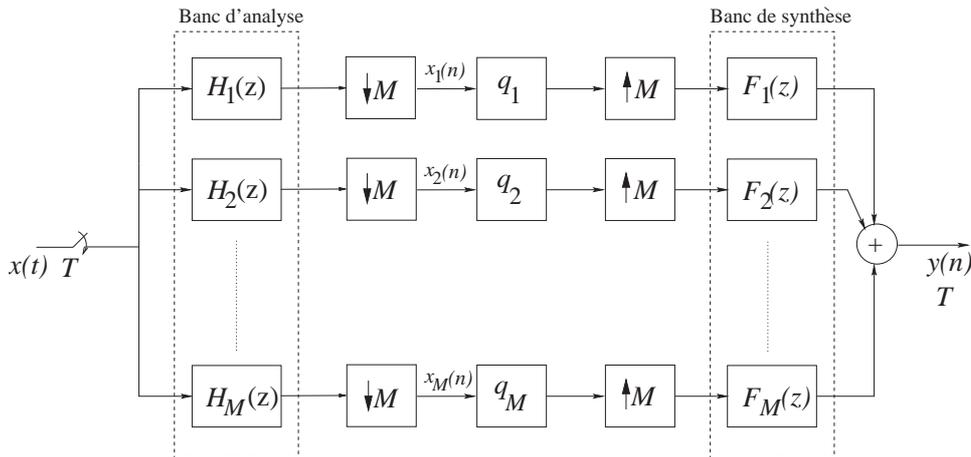
**Fig. 2.10** Banc de filtres hybride à temps discret
