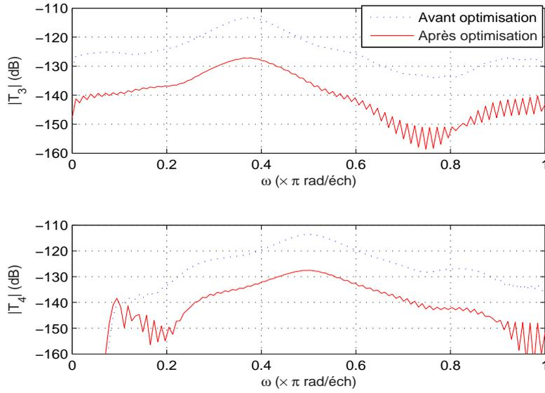
**Fig. 3.25** Module des fonctions de repliement  $T_3(e^{j\omega})$  et  $T_4(e^{j\omega})$  - en trait pointillé : sans optimisation des filtres d'analyse - en trait plein : avec optimisation
