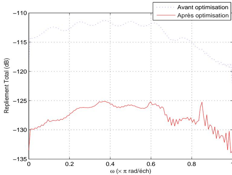
**Fig. 3.26** Replieement total - en trait pointillé : sans optimisation des filtres d'analyse - en trait plein : avec optimisation
