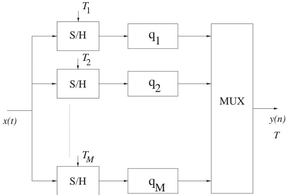
**Fig. 2.7** Convertisseur à entrelacement temporel - schéma fonctionnel
