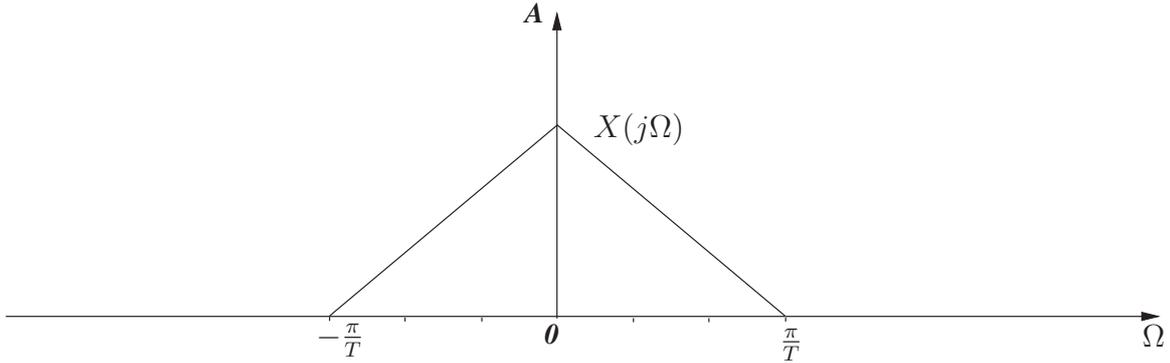
**Fig. 2.12** Spectre du signal d'entrée pour l'exemple 1
