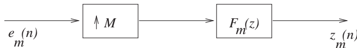
Fig. 4.2 – Le bruit de quantification est sur-échantillonné et filtré sur chaque voie du BFH
