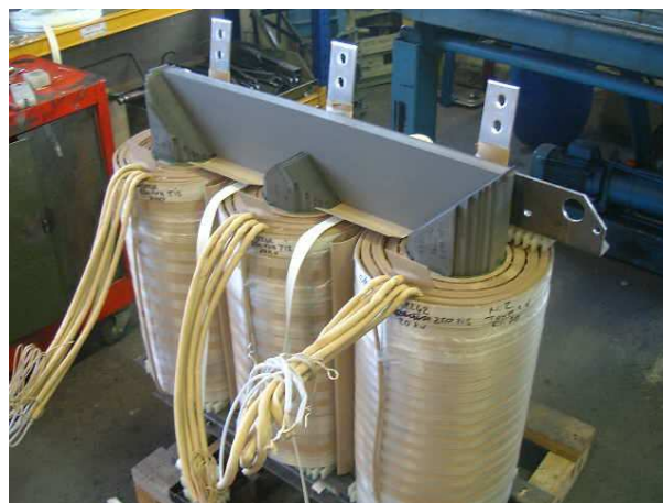
Figure 37. Partie Active du transformateur
