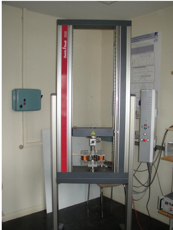
Figure 2.5 – Machine de traction/compression électromécanique
