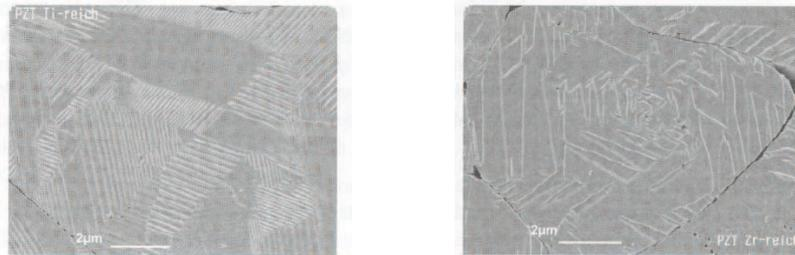
Figure 1.9 – Domaines ferroélectriques d'une céramique PZT, d'après [Setter, 2002]
