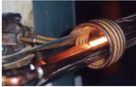
Fig. 3.2: Fusion de zone permettant l'homogénéisation et la mise en forme de l'échantillon.
