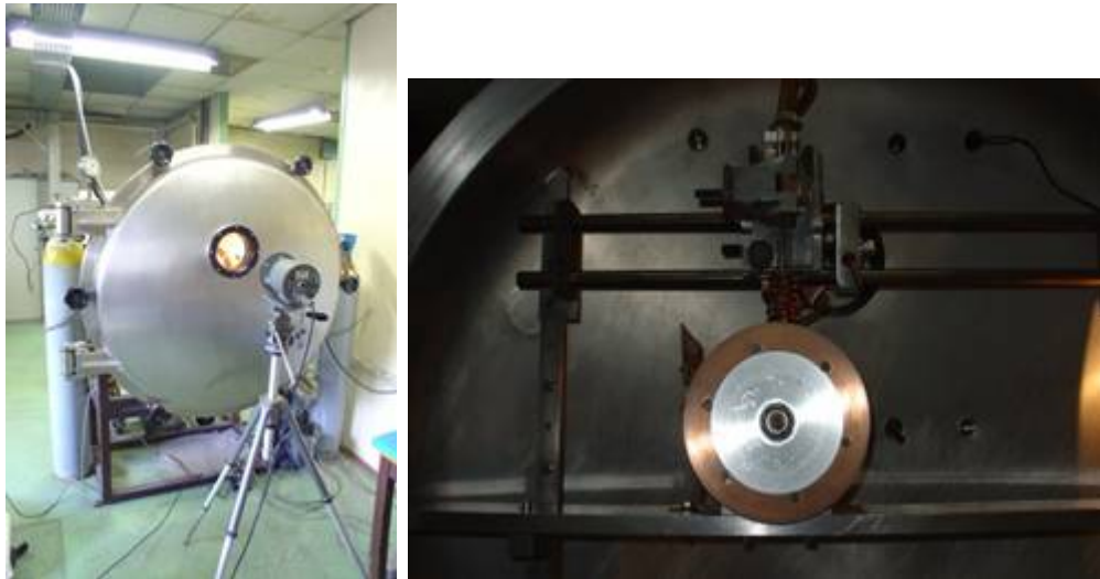
Fig. 3.3: A gauche : Le bathyscaphe contenant l'appareillage de melt spinning : la température de l'échantillon est contrôlée par un pyromètre optique. A droite : détails de l'appareil lui-même : une roue en alliage de cuivre cobalt béryllium de 20 cm de diamètre ; d'une buse en quartz comportant une fente d'environ 0,2 mm se situant à environ 0,15 mm de la roue ; d'un solénoïde permettant de faire rentrer en fusion l'alliage.
