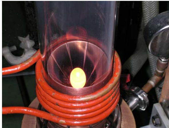
Fig. 3.1: Fusion en semi-lévitation magnétique. Le dispositif expérimental est sous atmosphère d'hélium afin d'éviter toute contamination et oxydation lors de la fusion. L'énergie est apportée au système sous la forme d'un champ magnétique par une bobine en cuivre recouvert d'une peinture diélectrique et refroidie par eau. L'échantillon en fusion se trouve alors en semi-lévitation.
