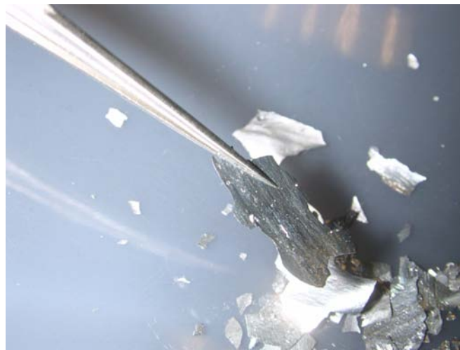
Fig. 3.4: Paillettes de quasicristaux d'AlCuFe. L'échantillon final se présente sous forme de paillettes d'environ 70 \mu\text{m} d'épaisseur et de quelques dizaines de \text{mm}^2 chacune.
