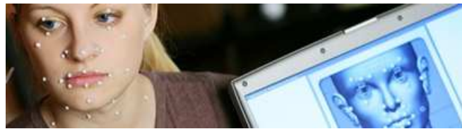
Figure 3.7 : Exemple d'un système de capture de mouvement associé à FaceRobot . A gauche : visage humain réel avec marqueurs superposés
