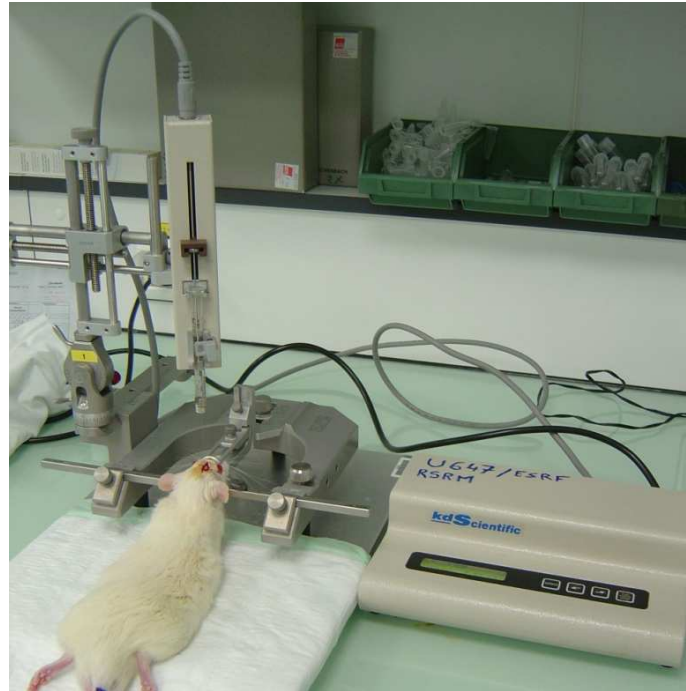
Figure IV-15 : Dispositif d'injection par CED. Le pousse seringue est monté sur le cadre stéréotaxique ; une aiguille de 32 gauge (montée sur une seringue Hamilton adaptée) est placée aux coordonnées stéréotaxiques voulues grâce aux translations micrométriques du cadre.
