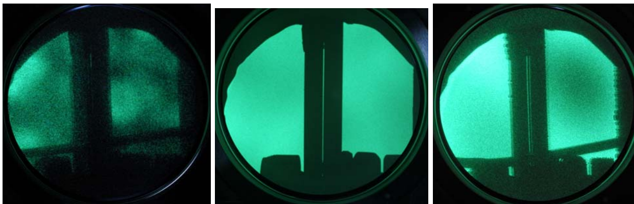
Figure 17 : Diagramme d'émission avec l'hydrogène, P_{H_2}=400\text{mbar} , V=10\text{kV} , I=2\text{pA}
