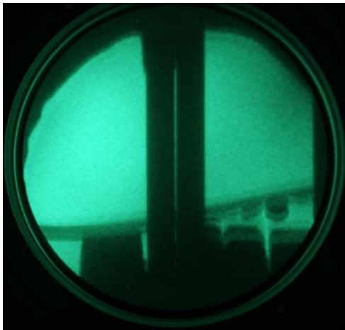
Figure 2 : Image de référence de la fente sans champ magnétique, V=2.5kV et P_{H_2}=340mbar
