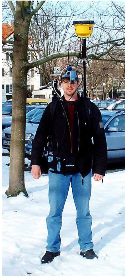
Abbildung 4.2: Systemaufbau bei Anzeige mithilfe einer halbdurchlässigen Brille
