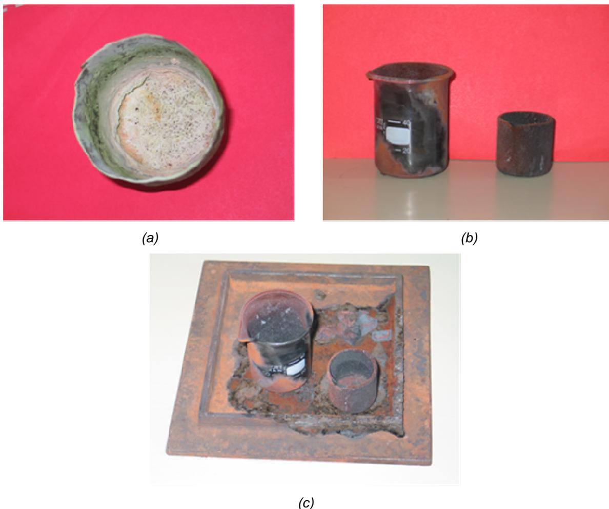
Figure 3.59 : Corrosion liée au chlorure de potassium : (a) sur un creuset en nickel, (b) sur un bécher en Pyrex et (c) sur de l'acier inoxydable.
