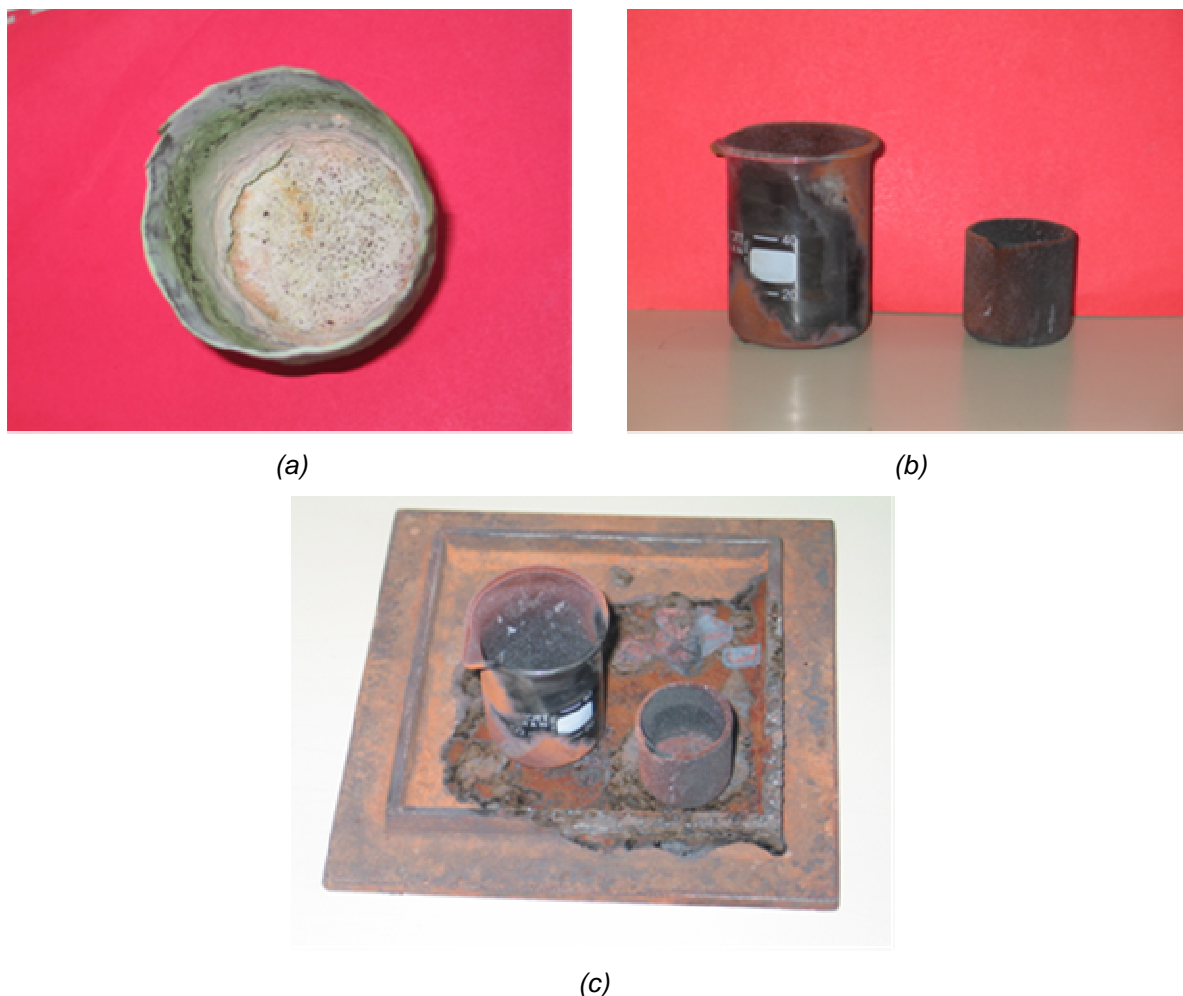
Figure 3.59 : Corrosion liée au chlorure de potassium : (a) sur un creuset en nickel, (b) sur un bécher en Pyrex et (c) sur de l'acier inoxydable.
