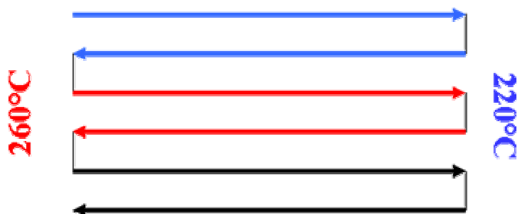
Figure 6.15 : Température imposée lors des cycles de cristallisation/fusion : en bleu les balayages à 10°C/min, en rouge celles à 5°C/min et en noir à 1°C/min.
