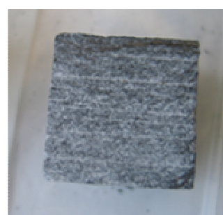
Figure 2.8 : composite KNO 3 /NaNO 3 + 10% m de GNE.
