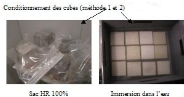
Figure A1 : Photographie des deux mode de conservation en ambiance humide utilisés
