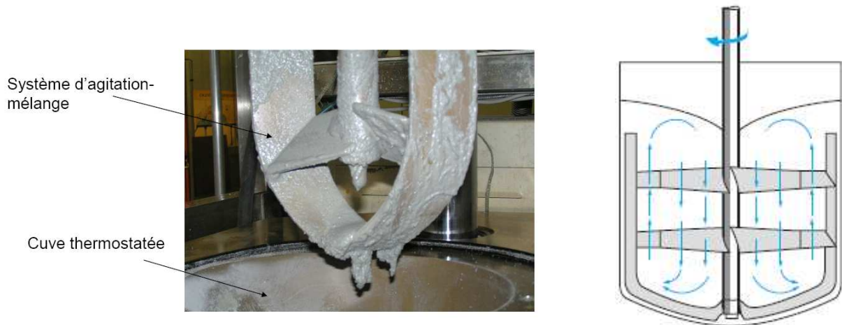
FIG. 66 Mélangeur pilote de 15 litres (à gauche). Boucles de circulation générées par le mobile d'agitation (à droite, cliché pris dans [58]).
