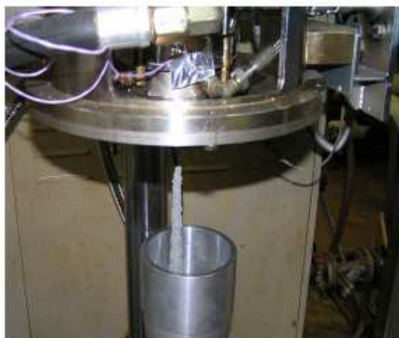
FIG. 67 Coulée gravitaire de 5700 \text{ cm}^3 de suspension énergétique concentrée à 85^\circ\text{C} .
