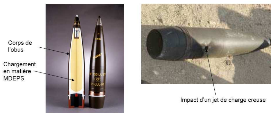
FIG. 35 Maquette de l'obus de 155 mm LU211-IM (à gauche). Impact d'un jet de charge creuse sur l'obus LU211 montrant son caractère insensible (à droite).
