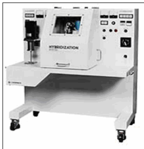
Figure I.11 : Installation complète du système Hybridizer Nara (Vilela, 2005)
