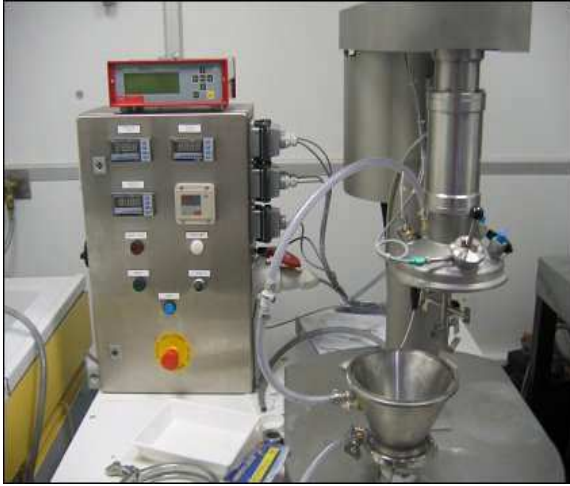
Figure II.4 : Installation complète du Cyclomix (Hosokawa)
