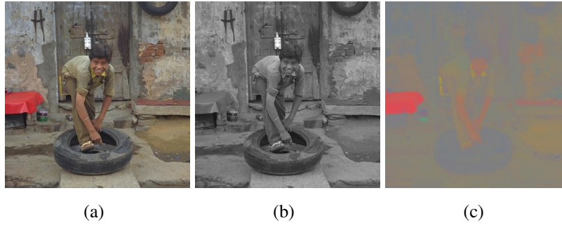
FIG. 2.7: Décomposition d'une image couleur (a) en intensité (b) et chrominance (c). Une valeur constante est ajoutée pour l'affichage de la chrominance.
