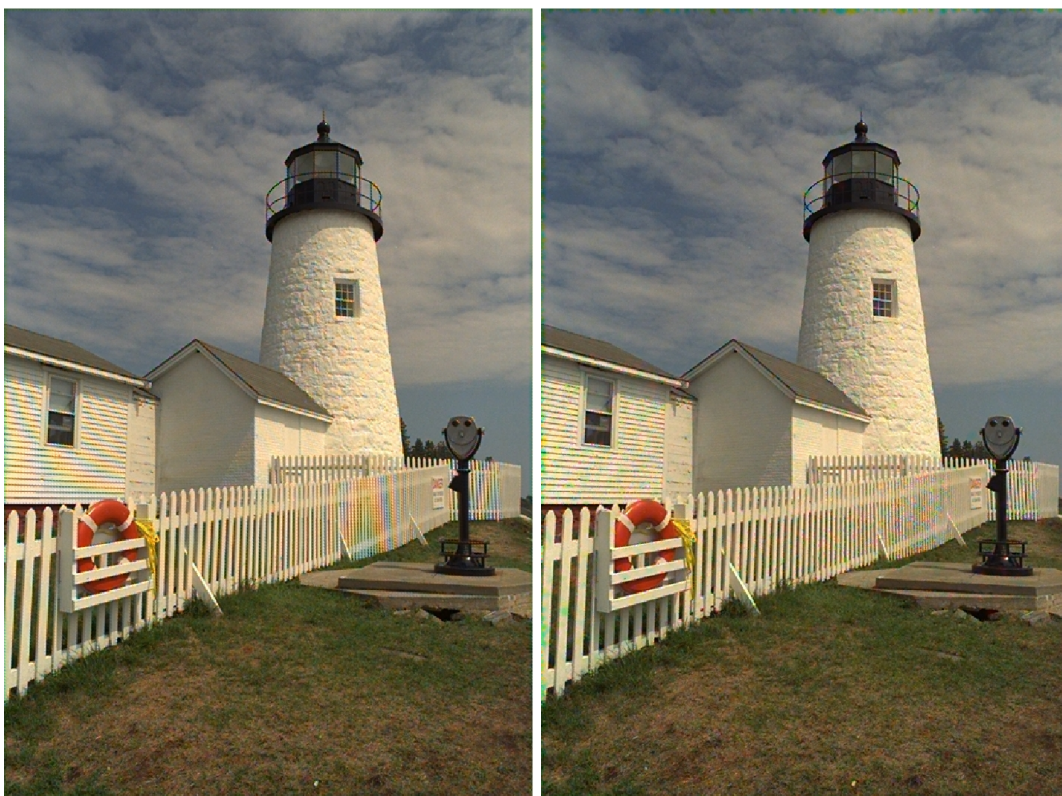
FIG. 4.22: A gauche : sous-échantillonnage régulier ; A droite : sous-échantillonnage irrégulier (Poisson). Dans les deux cas on a sous-échantillonné autant (1 échantillon sur 9 pour le rouge et le bleu) et la même technique d'interpolation a été appliquée. Les deux images ont un PSNR identique de 31.8dB. L'aliasing dans le cas régulier se retrouve sous forme de bruit dans le cas irrégulier.
