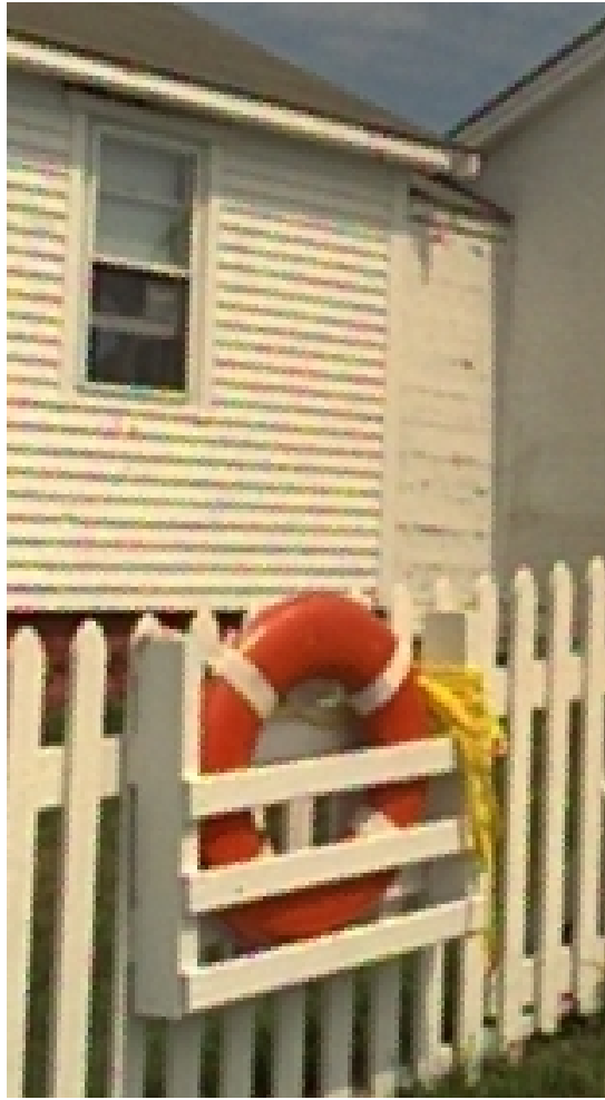
FIG. 5.9: Démosaïçage par estimation de l'intensité par convolution normalisée. La mauvaise estimation des hautes fréquences d'intensité se traduit par des contours irréguliers et par des fausses couleurs.
