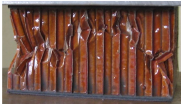
FIG. 3.23 – Apparition d'un mode macroscopique de flambement sur éprouvette NIDA-R-40 sollicitée en compression
