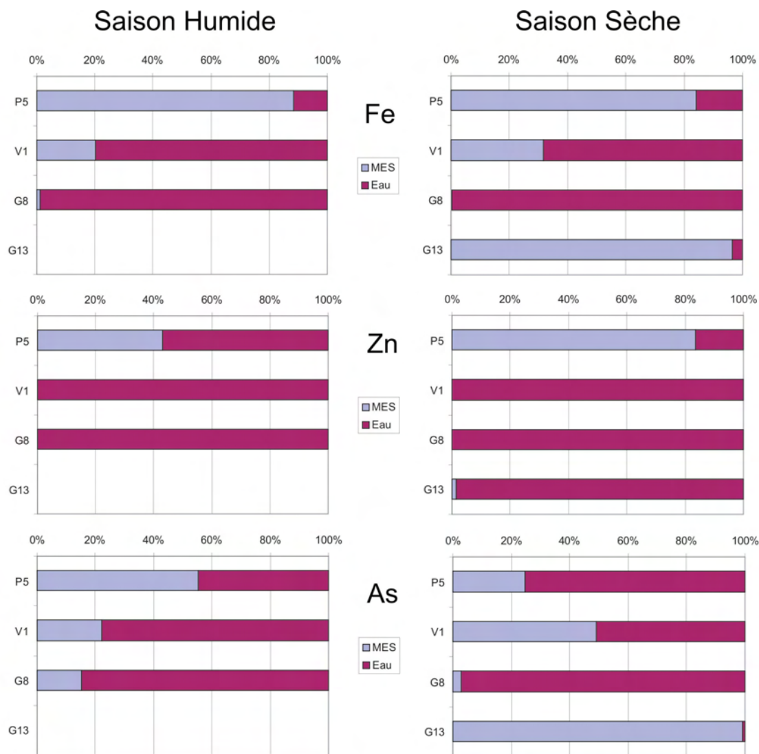
Figure III.46. Distribution des métaux (Fe, Zn, As) entre la phase dissoute (Eau) et en suspension (MES), et leur variation spatiale d'amont en aval (P5 à G13) dans le Val de Milluni, en saisons hydrologiques contrastées.
