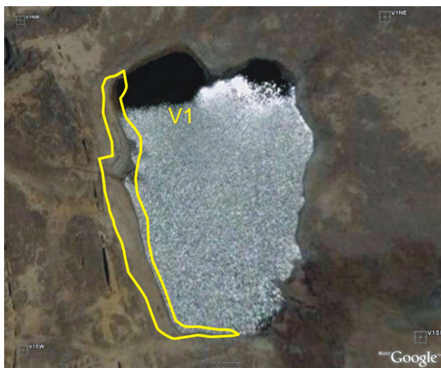
Figure IV.2. Surface considérée pour le calcul des stocks en métaux dans les sédiments du lac Ventanani (V1). Ce lac présente une granulométrie fine uniquement dans le secteur souligné en jaune, les autres versants sont affectés par des pentes très importantes avec très peu de sédimentation fine. La pente est aussi très marquée en profondeur, en effet ce petit lac (0.45 km 2 ) atteint jusqu'à 27 mètres de profondeur.
