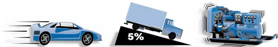
Figure 1.1. Applications des accéléromètres : mesure du mouvement, mesure de l'inclinaison, mesure de vibrations, mesure de choc (source : Analog Devices)
