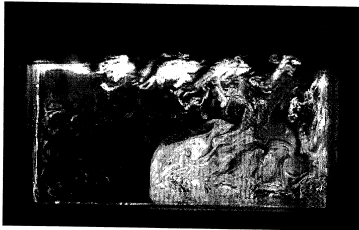
FIG. 4.9 – La recirculation est détachée de la partie amont et se concentre sur la partie aval de la cavité; L/H=2,2 .
